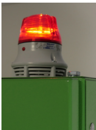
Un allarme visivo e sonoro, tramite sirena posta sulla macchina, avverte l'utente che sta prelevando impropriamente un pezzo; e della necessità di riporlo
