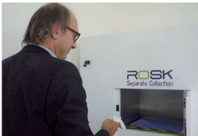
Una fase dello smaltimento di un DPI non riutilizzabile tramite la soluzione Rosk: Rosk traccia, fotografa ed identifica ogni singolo DPI depositandolo in modo selezionato in uno dei due bidoni in dotazione. Quando la saturazione si avvicina, invia una e-mail di avviso al responsabile
