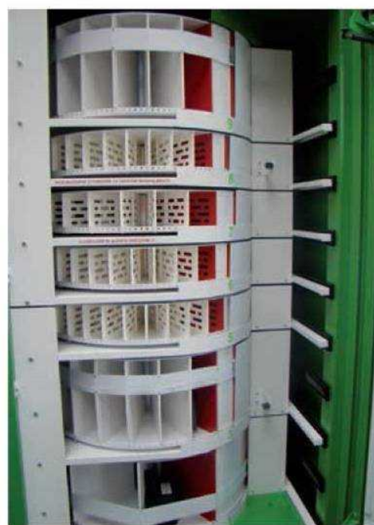
Il TomWork+ installato presso la L.T.E. in versione chiusa (a sinistra) e aperta. Il TomWork+ è una struttura modulare e modulabile, un vero e proprio "magazzino intelligente" realizzato da Indaco Project ed utilizzato in L.T.E. per la gestione delle apparecchiature, a cominciare dai palmari
