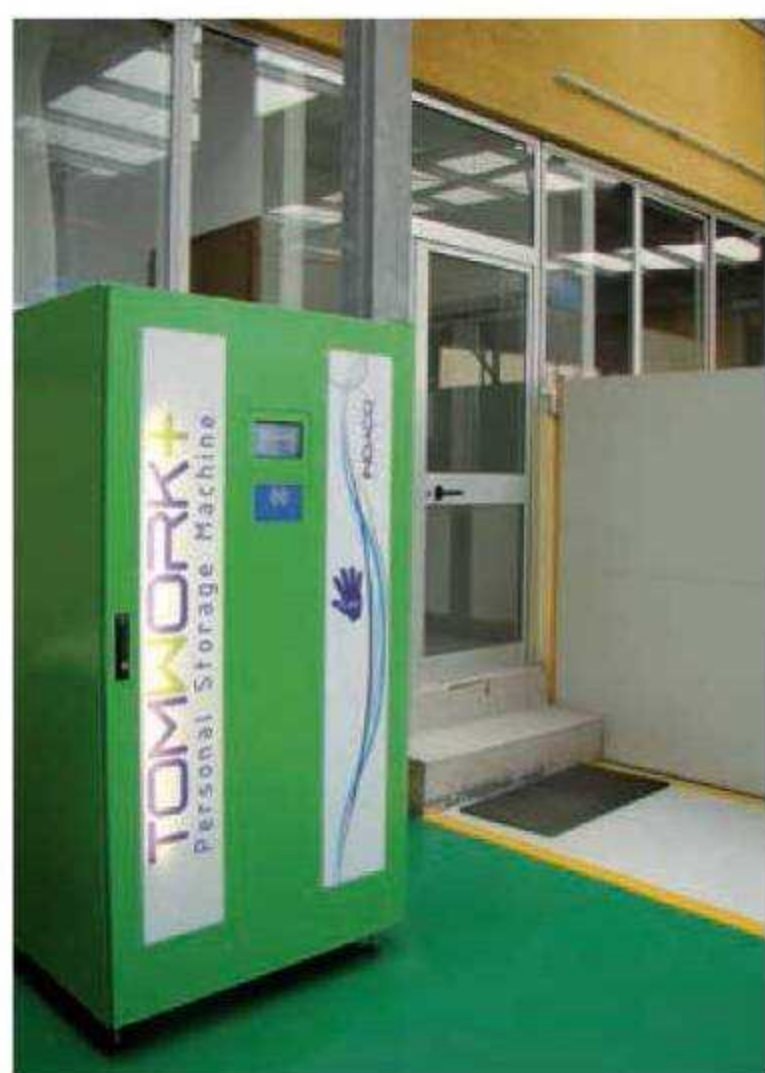
Il TomWork+ installato presso la L.T.E. in versione chiusa (a sinistra) e aperta. Il TomWork+ è una struttura modulare e modulabile, un vero e proprio "magazzino intelligente" realizzato da Indaco Project ed utilizzato in L.T.E. per la gestione delle apparecchiature, a cominciare dai palmari
